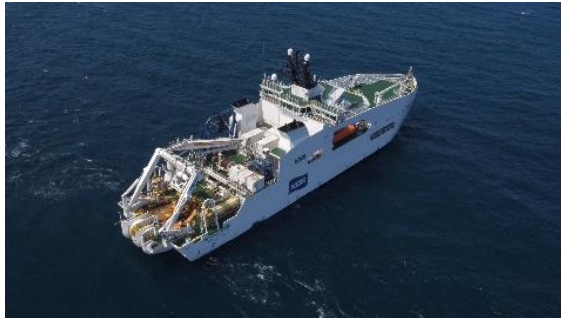
海底ケーブル敷設船
