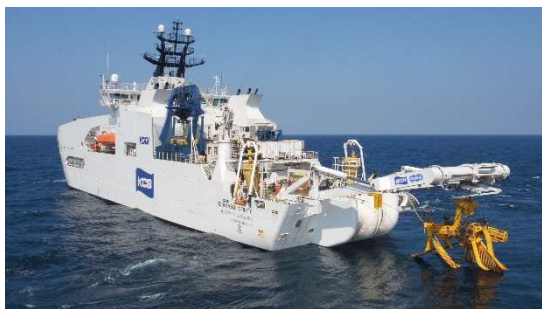
CLV：海底ケーブル敷設船 (提供：国際ケーブル・シップ株式会社)
