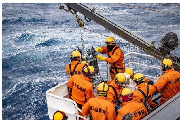
CTD/RMS：採水システム付き水温・塩分・圧力による深度測定装置による観測の様子（提供：国立極地研究所）
